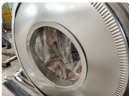
Установка боковых щитов и углов
