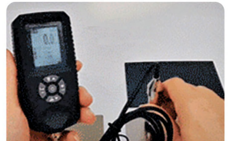
Prueba de Capa de Zinc
